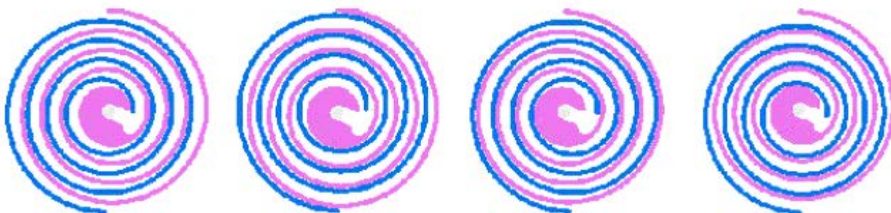
Рис. 2 Принцип работы спирального насоса
