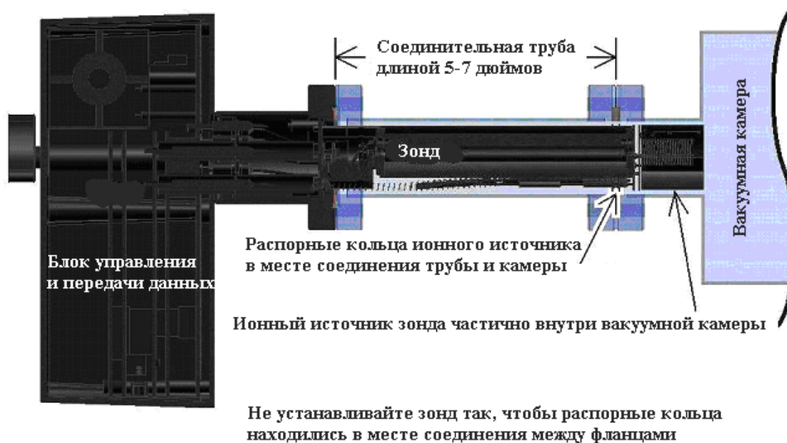
Рис. 58. Зонд установлен так, что распорные кольца находятся в месте соединения между фланцами
