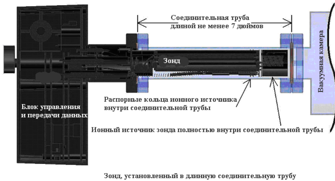
Рис. 57. Установка зонда в длинную соединительную трубу
