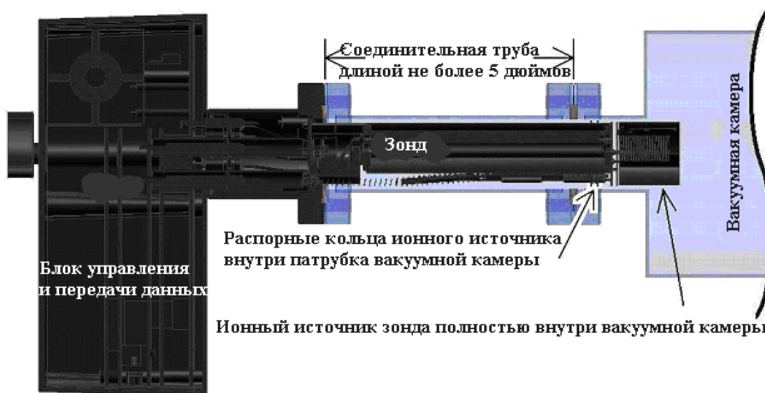
Зонд, установленный в короткую соединительную трубу
