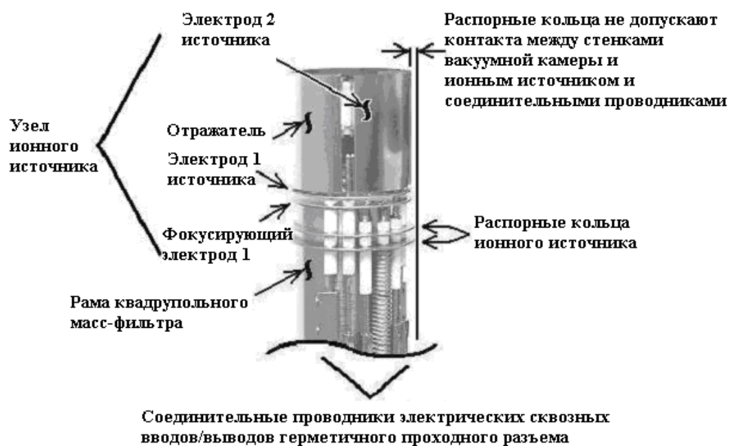
Рис. 54. Расположение распорных колец ионного источника
