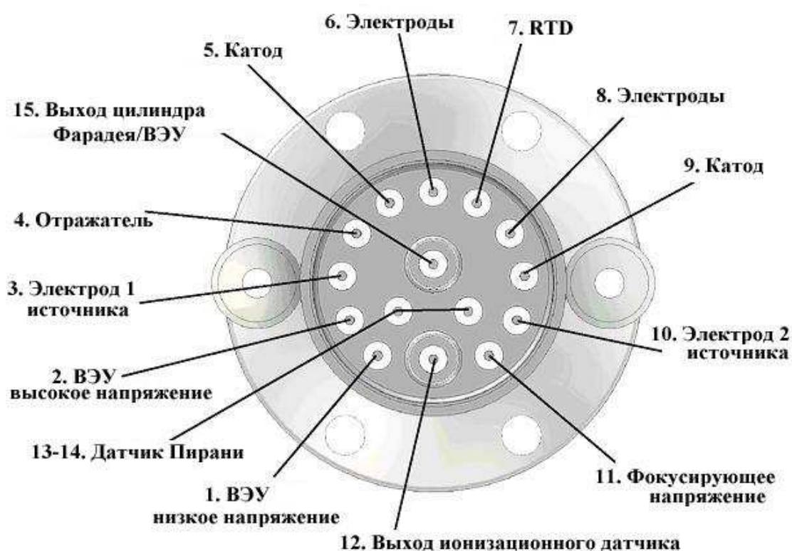
Рис. 40. Расположение сквозных вводов/выводов на фланце
