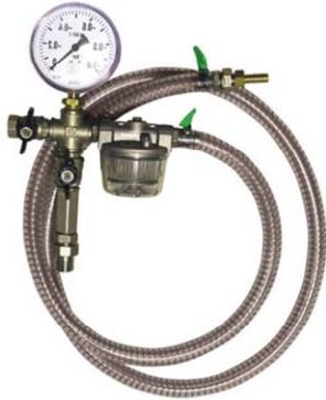
Данный комплект состоит из вакуумного шланга для подключения вакуумного мешка к насосу в комплекте с фланцами, вакуумметром, отсечным клапаном, клапаном напуска атмосферы и вакуумным фильтром. Служит для подключения одного вакуумного мешка к вакуумному насосу. Подходит для всех вакуумных насосов, использующихся в СВП.
