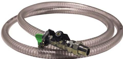
Данный комплект состоит из вакуумного шланга для подключения вакуумного агрегата к вакуумному мешку. В отличие от комплекта для подключения к обычному вакуумному насосу, в этот комплект не входят вакуумметр и фильтр, так как они входят в состав вакуумного агрегата. Используя такие комплекты для подключения к одному вакуумному агрегату можно подключить до 2-х вакуумных мешков одновременно.
