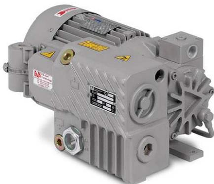
**Вакуумные насосы серии L**- классические маслосмазываемые пластинчато-роторные вакуумные насосы, сочетающие проверенный годами принцип работы и инновационные разработки DVP. Все вакуумные насосы данной серии имеют циркуляционную систему смазки со встроенным высокоэффективным блоком маслосепарации, обеспечивающим значительное снижение концентрации паров масла в выбрасываемом воздухе, очистку масла посредством масляного фильтра и охлаждение масла до рабочей температуры.
