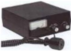
Несмотря на то, что этот СИД горит, когда заряжается аккумулятор, блок отображает результат измерения только когда переключатель в позиции «CAL» или «READ».
