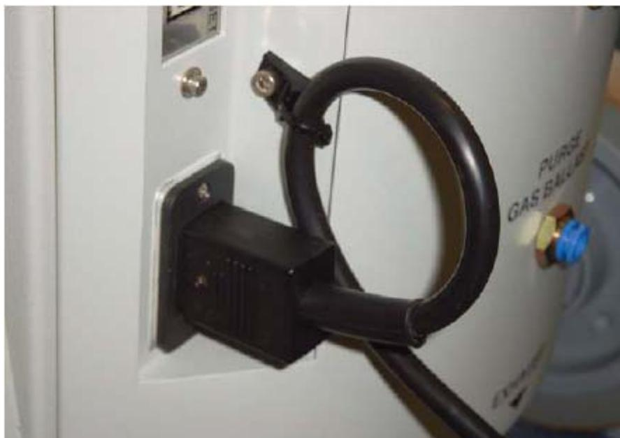
Рис. 2-4. Фиксатор шнура питания
