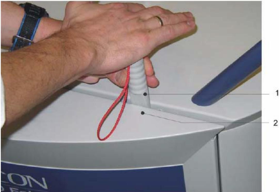
Рис. 9-1. Открытие корпуса течеискателя UL1000 Fab или UL1000
