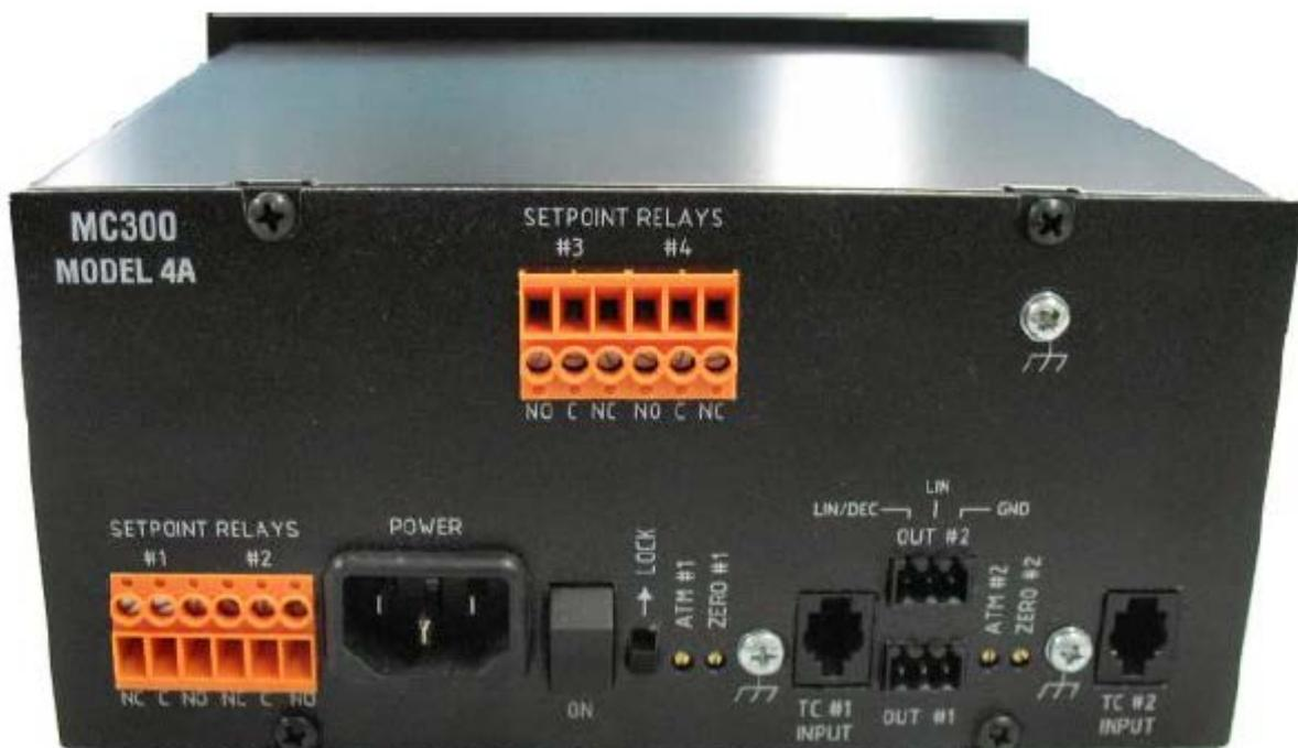
Рис. 2. Задняя панель 4А
