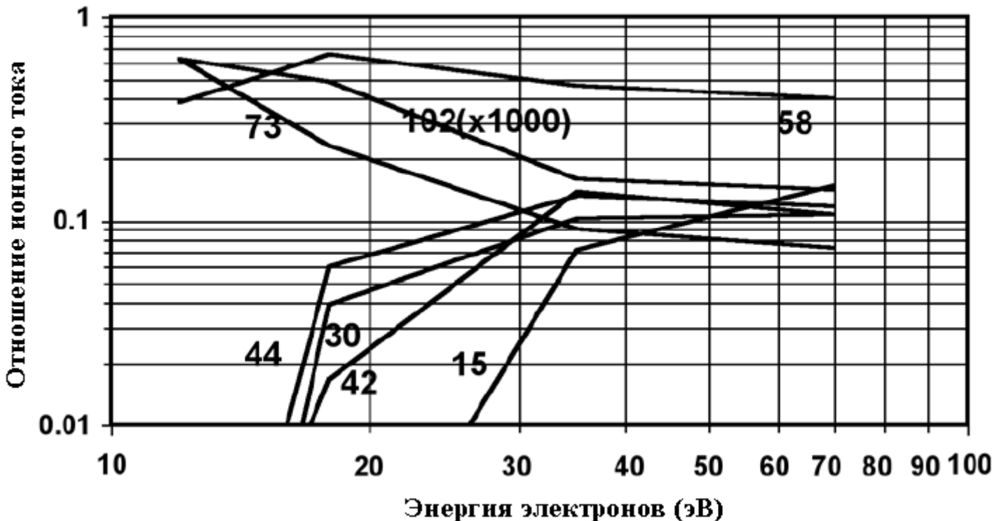
Рис. 4. Отношение токов ионов выбранных масс к общему току ионов для выбранных фрагментных ионов DMEAA при различных энергиях электронов
