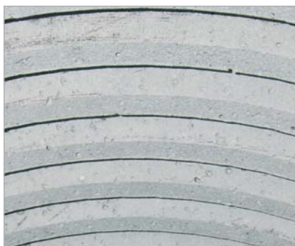
Нагреватели в виде спирали в углублениях жаростойкого бетона
