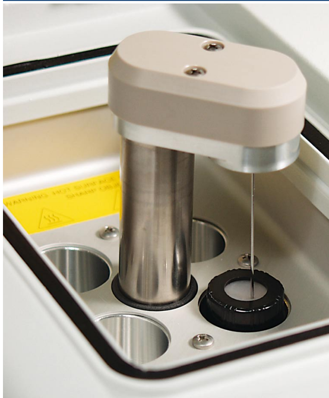
Печь вмещает четыре стандартных виалы объёмом 40 мл. Игла легко вставляется для извлечения пробы.
