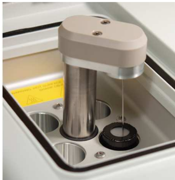
Печь вмещает четыре стандартных виалы объёмом 40 мл. Игла легко вставляется для извлечения пробы.
