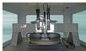
Сенсоры для лицевой и обратной поверхности пластины
