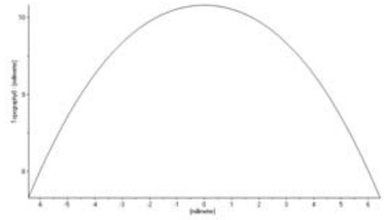
измерение профиля поверхности асферической линзы
