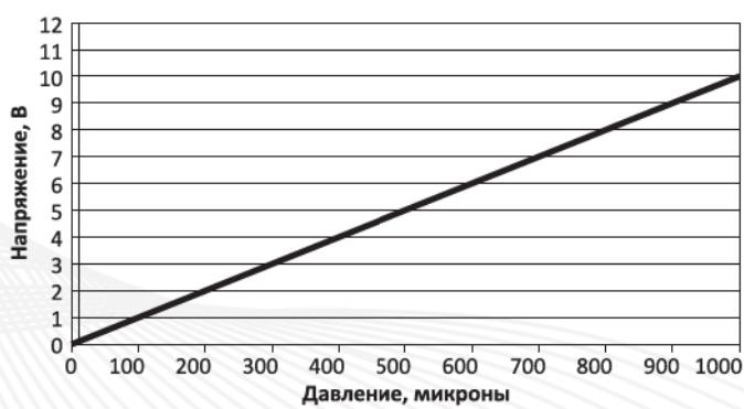
**КОНВЕКЦИОННЫЙ ВАКУУММЕТР****MP4AR****Диапазон измерений: атмосфера -  $10^{-3}$  Торр**
