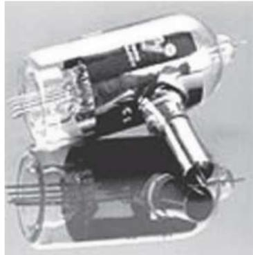
Тип 8142 – это универсальный датчик, в чью конструкцию входит компактная двуниточная решётка и покрытая торием иридиевая нить накаливания. Внутри корпуса платиновое покрытие, защищающее компоненты датчика от электростатических и статических ударов, которые могут появляться при различных условиях эксплуатации. Этот датчик содержит огнеупорную покрытую торием иридиевую нить накала. Датчик может быть выполнен в специальном компактном долговечном корпусе.
