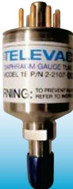
Мембранный датчик измеряет абсолютное давление, определяя смещение диафрагмы под действием этого давления. Показания датчика не зависят от рода газа. 1E и 1F мембранные датчики обеспечивают широкий диапазон измерений, быстрый отклик и чрезвычайно точные измерения
