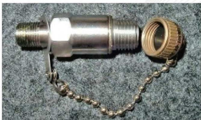
VacuMini можно устанавливать в любом положении в пространстве. Если в вашей вакуумной системе присутствуют вещества, которые могут служить загрязнением для датчика вакуума – Televac предлагает специальные фильтры для защиты датчиков.
