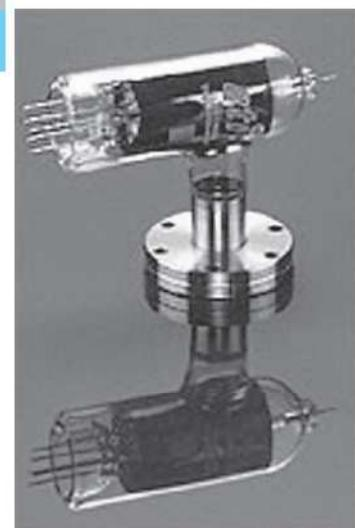
ETI 8136 - это широкодиапазонный датчик Баярда-Альперта. Специально изготовленные элементы датчика и огнеупорная покрытая торием иридиевая нить накала делают возможным работу датчика при давлении до  $1 \times 10^{-1}$  Торр. Имеются версии датчика с повышенным сроком службы.
