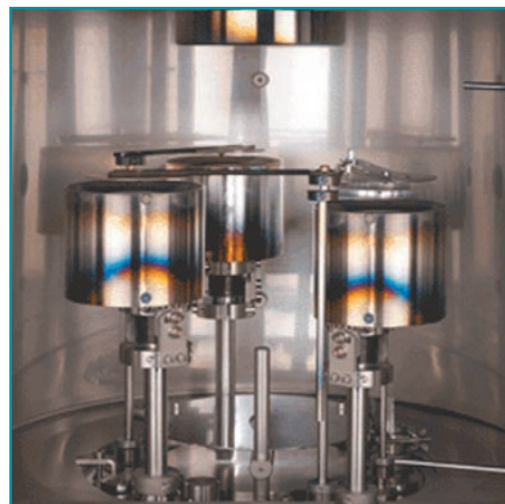
■ Камеры FL500 с тремя источниками распыления диаметром 3" с наклонными головками.
