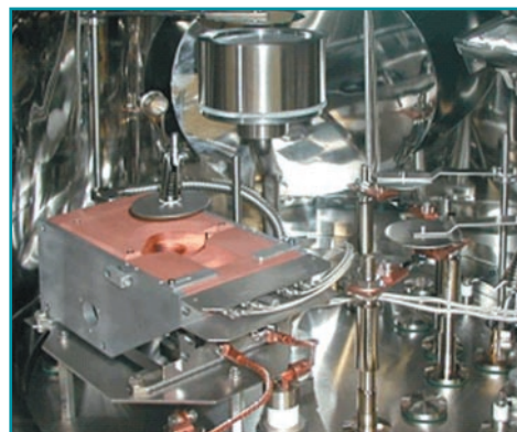
■ Камера TF600 с электронно-лучевым источником мощностью 6 кВт, источником магнетронного распыления и резистивными источниками размером 4"
