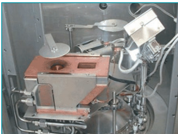
■ Камера FL400 изнутри с электронно-лучевым источником EB3, двумя резистивными источниками и кварцевым ламповым нагревателем подложки.
