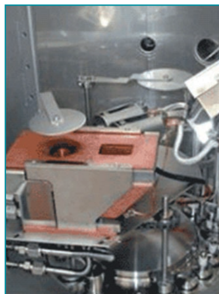
■ Камера FL400 внутри с электронно-лучевым источником EB3, двумя резистивными источниками и кварцевым ламповым нагревателем подложки
