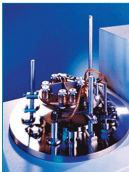
■ Auto306 с резистивным источником на 4-позиционном поворотном столике
