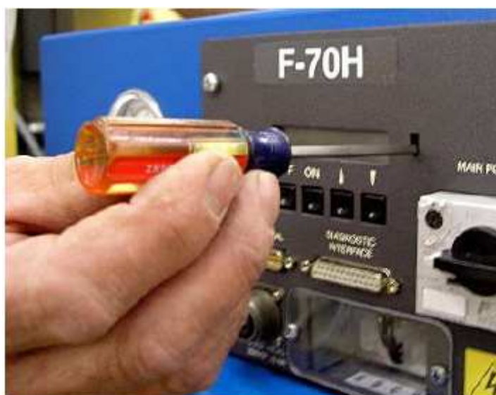
Рисунок 11 Установка режима при помощи переключателя
