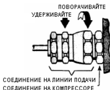
Рисунок 10 Подсоединение линии подачи газа к компрессору или охлаждающей головке
