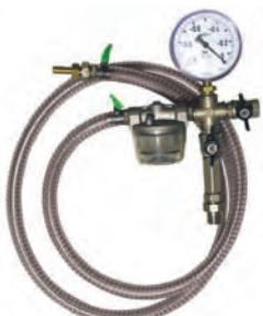
Комплект состоит из вакуумного шланга для подключения вакуумного мешка к насосу в комплекте с фланцами, вакуумметром, отсечным клапаном, клапаном напуска атмосферы и вакуумным фильтром. Служит для подключения одного вакуумного мешка к вакуумному насосу. Подходит для всех вакуумных насосов, использующихся в СВП.
