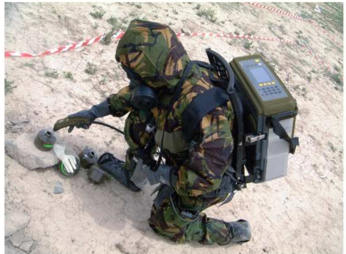
HAPSITE пригоден как для установки на транспортном средстве, так и для мобильного исследования силами одного человека с целью обнаружения и идентификации химических веществ.
