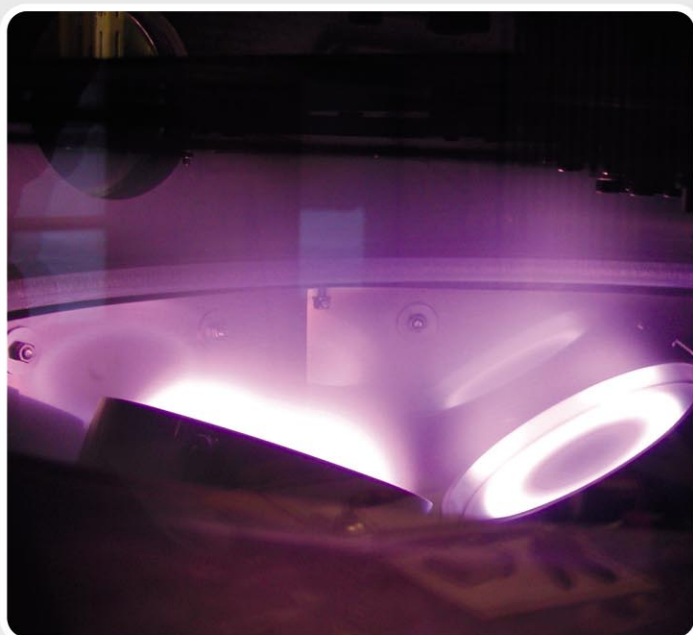
Совместное осаждение с использованием высокочастотного магнетрона и магнетрона постоянного тока.
